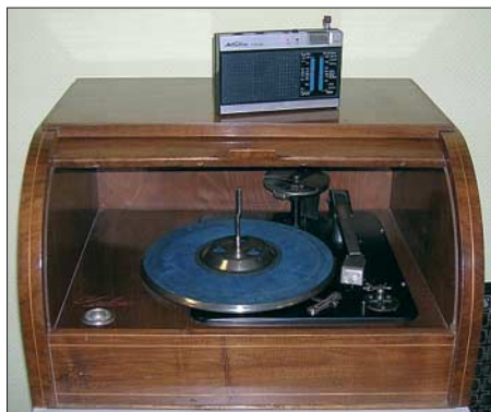
Bild 7: Das Transistorradio „Florida“ und die „Brottrommel“ - der Plattenspieler war das erste Kuba-Produkt überhaupt und hatte eine Nadelaufgabe von 0,5 N.
