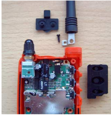
Zerlegtes Gerät; deutlich erkennbar ist die kleine Schraube der Antennen-Befestigung.
