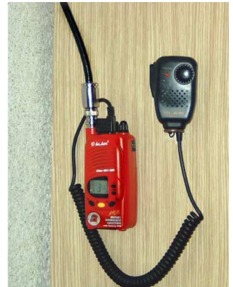
Das fertige PMR in Lauerstellung. Tipp: verschraubt man den Gürtelclip mit einer kleinen Strebe z.B. am Schrank, hält es wackelfrei und man kann das Gerät jederzeit per Dauerndruck bequem abnehmen.
