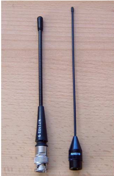
Links im Bild ein einfacher 1/4-Strahler für 70 cm; rechts die hochflexible RH519, die beste Leistungen auf 446 MHz bringt (Top!)
