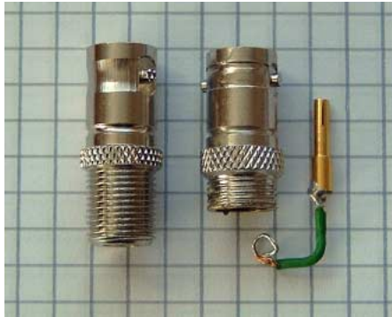
Die Arbeitsschritte im einzelnen: Original-Adapter; gekürzte Buchse; Mittenkontakt mit verlötetem Kabel.
