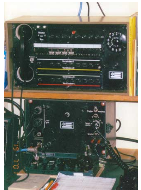
Bild eines BOS-Telefonkopplers (Gerät unten) zur Handvermittlung
