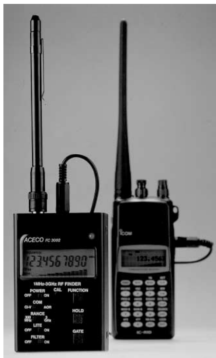
Der angeschlossene Scanner, hier ein ICOM IC-R 10, gibt die vom Aceco gefundenen Signale sofort wieder.
