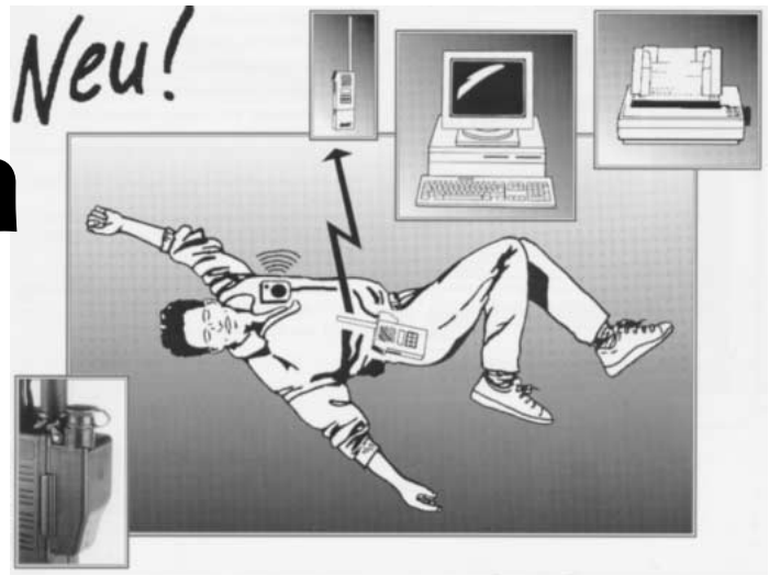
Kleines Bild links unten: Zwischenstecker mit Totman-Alarmgeber. An der 12-Pin-Buchse können Headsets oder externe Mikrofone angeschlossen werden. Der Alarmgeber kann über den PC programmiert werden. Zeichnung: CT
