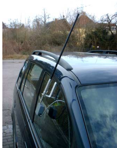
Die 2,4-GHz-Mobilantenne MG-200, die direkt am Eigenbau-„LNB“ betrieben wird.
