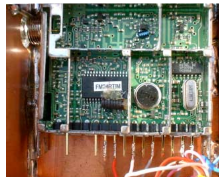
Der Video-Tuner mit geöffnetem Deckel. Gleich unter dem großen IC befindet sich die kleine Spule. Der Ferritkern wurde nach einigen Versuchen direkt darauf geklebt.
