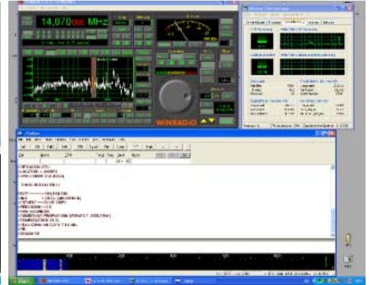
Bild 6: PSK-Empfang mit DigiPan. Der Taskmanager dokumentiert die moderate CPU-Belastung.
