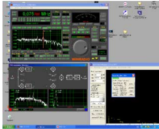
Bild 5: Zeitzeichenerfassung und Blockdiagramm des Demodulators.
