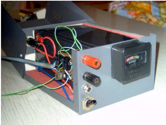
Bleigel-Akku im Gehäuse: Ein lageunabhängiger Bleigel-Akku sorgt für die nötige Stromversorgung.
