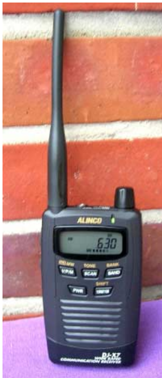
Nur wenige Bedienelemente: Der Drehregler mit Dreifachfunktion ist ziemlich gewöhnungsbedürftig.
