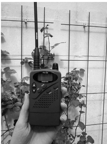
Der FR-100 hat gegenüber dem Vorgängermodell AR-108 einen vergrößerten Frequenzbereich (66 bis 470 MHz).
