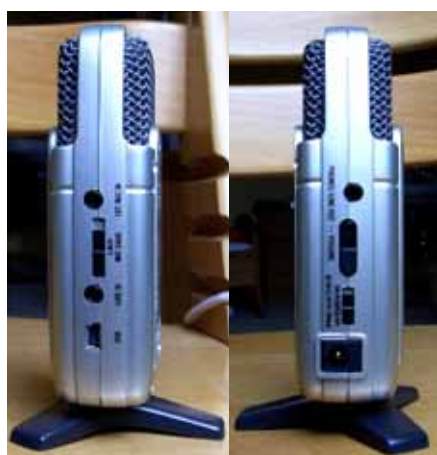
Hier kann man gut die seitlich angebrachten Bedienelemente und Buchsen sowie den Mikrofonkopf mit dem stabilen Gitter erkennen.
