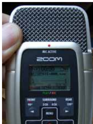
LEDs wie Mic active und Front 90° informieren über den Betriebszustand.
