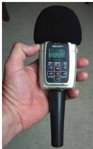
Windschutz und Handhalter zum Dämpfen störender Geräusche.
