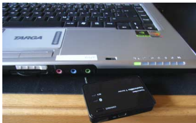
Wie bei diesem Targa-Notebook, sind die Audiobuchsen oft ins Gerät eingelassen, so dass der festmontierte Stecker des Bluetooth-Senders ohne Einsatz eines Verlängerungsstückes keinen Kontakt findet.
