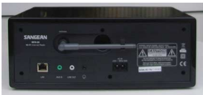
Die WLAN-Antenne ist eingeklappt und verdeckt fast das Bassrohr, darunter die Anschlüsse für den Router/LAN (links) und für Audio.
