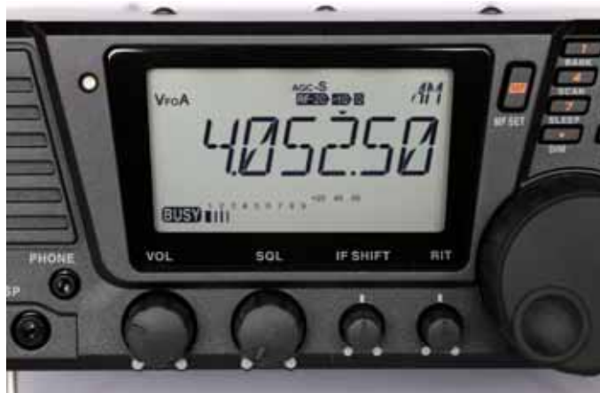
Bedienfeld des DX-R8. Unter dem kontrastreichen LC-Display liegt u.a. der Drehknopf für IF Shift (Passband Tuning).
