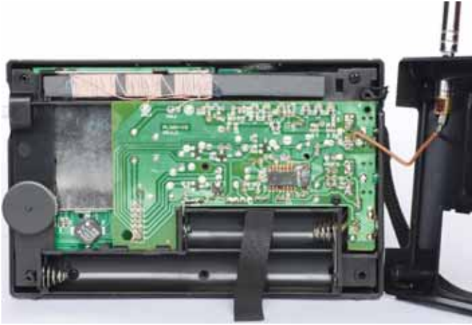
Ein Blick ins Innenleben des PL-310: Oben ist die Ferristabantenne für Lang- und Mittelwelle zu sehen.
