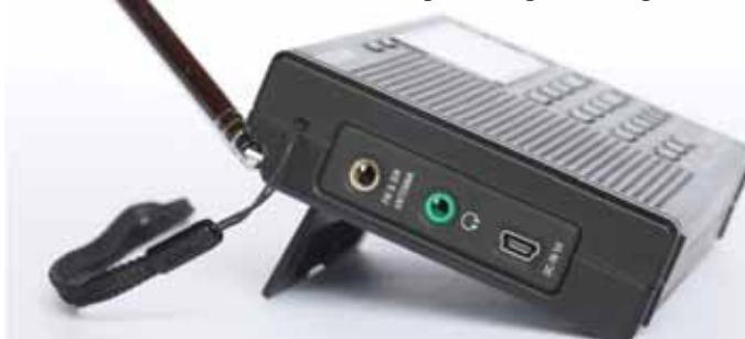
Auf der linken Seite liegen auch die Anschlussbuchsen. Eine Trageschleife ist fest mit dem Empfänger verbunden.
