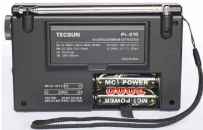
Das Batteriefach auf der Rückseite des PL-310 nimmt drei Mignon-Zellen auf.
