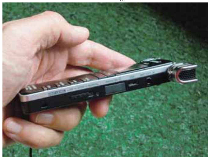
Hier sieht man sehr schön, wie klein der VR-20 geraten ist. USB- und Mikrofonbuchse, die Speicherkarte unter einer Gummikappe und der Empfindlichkeitsschieber sind deutlich zu erkennen. Fotos (2): urc
