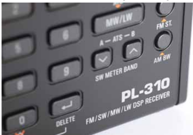
Der Empfangs-IC mit DSP ermöglicht im PL-310 fünf schaltbare AM-Bandbreiten (AM BW).
