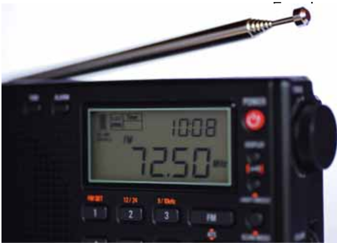
Die UKW-Frequenzlisten der Online-Datenbank FMList helfen bei der Identifizierung zunächst unbekannter Sender – auch während so genannter Überreichweiten im osteuropäischen OIRT-UKW-Frequenzbereich, den aktuelle DSP-Weltempfänger wie der Teccsun PL-310 erfassen. Foto: Harald Kuhl
