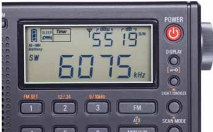
Das große und übersichtliche LC-Display zeigt die aktuellen Empfangsparameter an. Über die Empfangsfeldstärke informiert der Empfänger in exakten numerischen Werten. Fotos: Harald Kuhl
